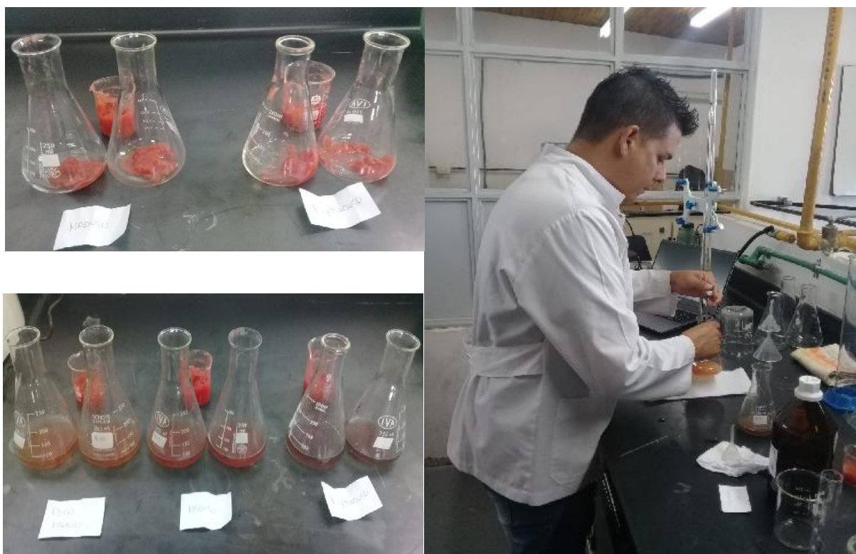
Foto: etapas de procedimiento realizado con muestras de tomate en diferentes estadios madurativos y en ambas variedades. Foto sup.izq.: preparación de muestras para determinar acidez. Foto derecha: Lic. Mario Villano realizando las determinaciones. . Foto inf.izq.: resultado final luego de la titulación. Fuente: Héctor Claudio Fioretti (2023)
