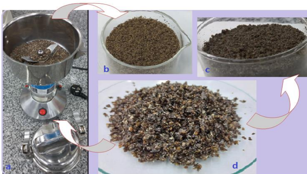
Figura 5: Molinillo alta velocidad multifunción Grinder (a). Semilla molida (b). Subproducto o expeller (d). Subproducto molido (c).
